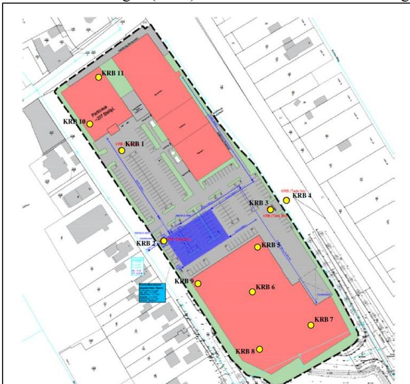
Abbildung 2: Standorte der Kleinrammbohrungen (KRB) im Untersuchungsgebiet
